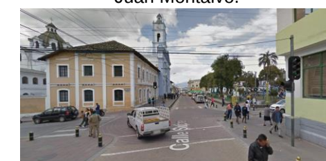
Intersección Semaforizada Sucre y Terán. Déficit señales horizontales peatonal sobre Terán.
